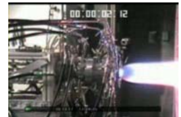
アブレータ高圧耐久性データ取得試験
