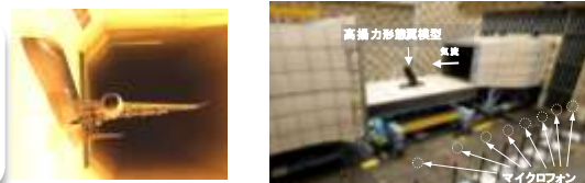
飛行実証対応風洞試験による詳細な騒音計測
