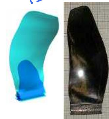
中空CFRPブレードモデル試作
