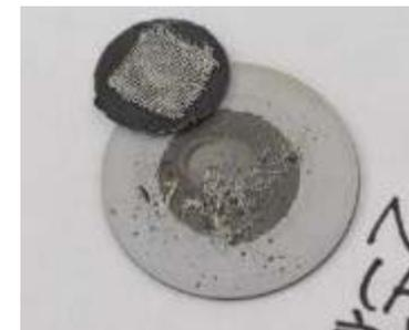
水素流量変動の影響で破損した固体酸化物形燃料電池
