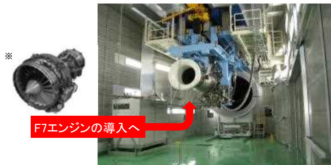
地上エンジン運転試験設備
