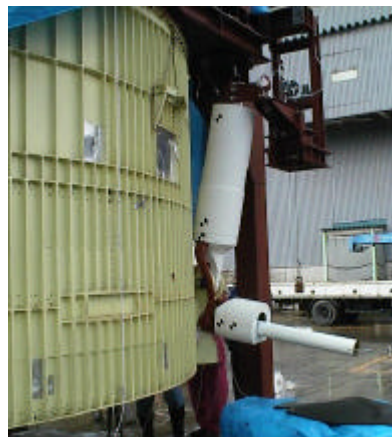
エンジン部/S R B - A分離衝撃試験
