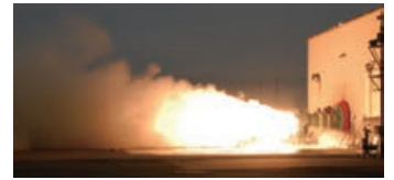
強化型イプシロンロケット2段モータ(M-35)真空地上燃焼試験 Static firing test of Enhanced Epsilon Launch Vehicle second-stage motor (M-35) in vacuum
