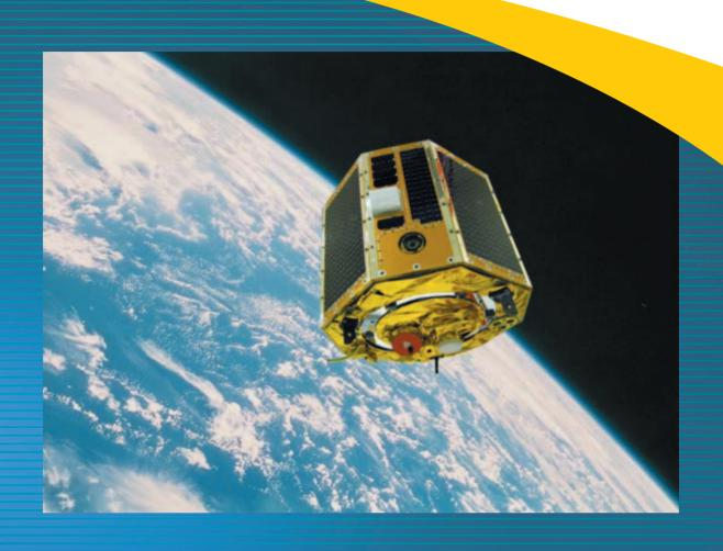
μ-LabSatなどの小型研究衛星は、宇宙機をより小型高機能化することが目的の衛星です。小型衛星は、短期間に安価な経費で、新規に開発した宇宙機用機器・部品の実験や実証ができます。このような技術実証を積み重ね、宇宙機の小型高性能化が進むものと期待されています。近年は、国内外のロケットにピギーバック衛星(ロケットの余剰能力を活用して相乗りさせた小型副衛星)として小型衛星を搭載する機会が増加しており、小型衛星に関する役割も注目されています。
