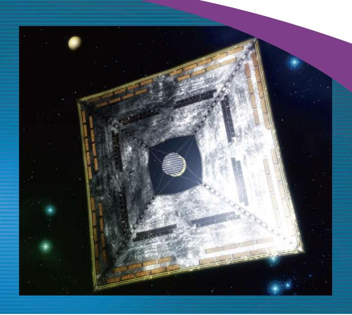
ソーラーセイルは、超薄膜の帆を広げ太陽光圧を受 けて進む宇宙ヨットです。ソーラー電力セイルは、帆の 一部に薄膜の太陽電池を貼り付けて大電力発電を同時 に行います。この電力を用いて高性能イオンエンジンを 駆動することで、ハイブリッド推進を実現し、効率的で 柔軟なミッションが可能となります。
