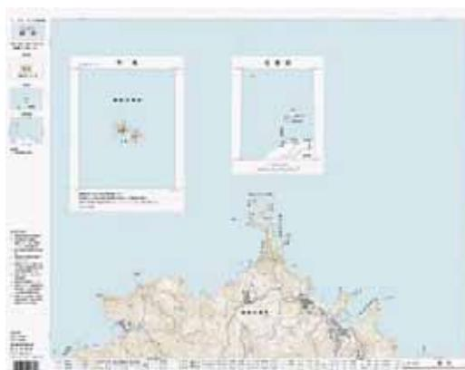
ALOSデータを利用し、現地測量なしで作成された日本初の竹島地形図
