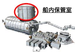
平成19年4月に船内保管室をNASAケネディー宇宙センター(KSC)の宇宙ステーション整備施設(SSPF)へ搬入し、重量・重心計測、据付を実施するとともに、輸送後機能確認試験を実施し、NASA主催のスペースシャトル(以下「シャトル」という。)搭載審査(CIR)に参加し、打上げに問題がないことを確認した。その後、シャトル搭乗員による打上げ前実機確認(CEIT)及び微生物検査、ドライエア充填及びハッチクローズ作業を実施した。
