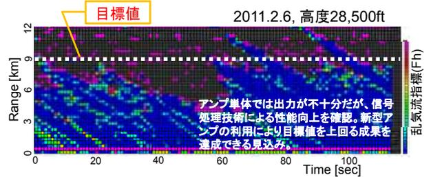
高高度モデル(FY20開発光アンプ内蔵)による飛行実験データ
