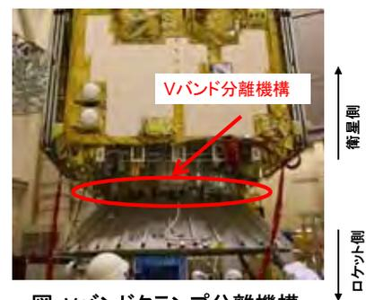
図: Vバンドクランプ分離機構
