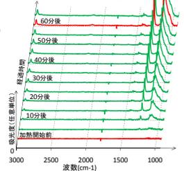
汚染ガス付着による光学劣化データの時間変化
