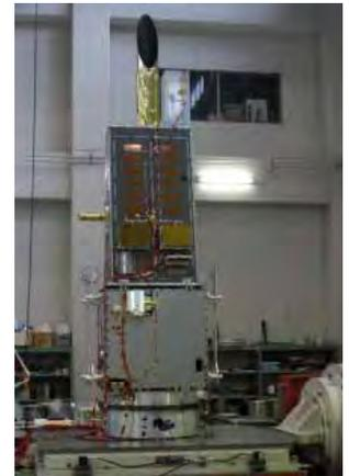
1号機システム構造試験モデル
