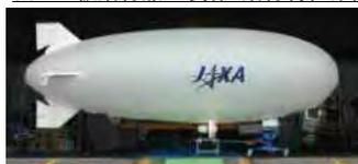
製作した試験機(12m級飛行船型無人機)
