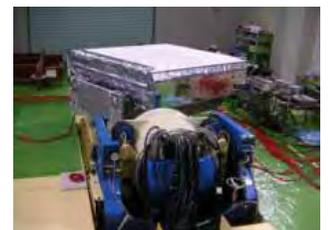
図16 KuPR正弦波振動試験
