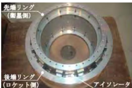
図4 制振機構(供試体)
