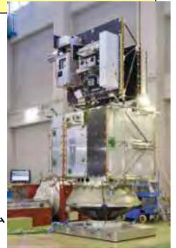
GCOM-C1システム熱構造モデル試験
