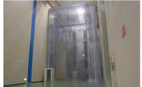
図5 音響設備前 クリーンテント設置による清浄度確保
