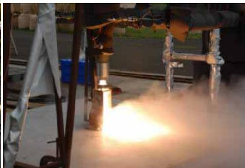
図2 音響環境計測燃焼試験
