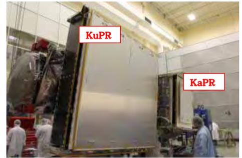
GPM主衛星に取り付けられたDPR(NASA提供)
