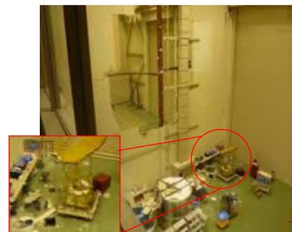
図2 試験棟壁崩落によりクリーンルーム機能を喪失。衛星打上げ実機及び設備全般が粉塵汚染
