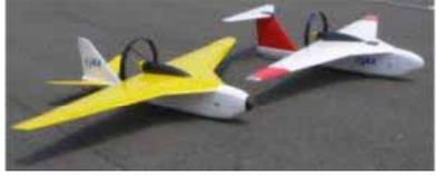
空力形状、推進系統等の見直しによる機能強化(T尾翼化による低速高降下角着陸、推力増大・バッテリー増量による飛行時間増大など)
