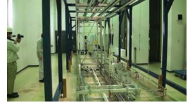
展開トラス地上実証実験の様子
