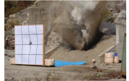
図:はやぶさ2衝突装置 飛行性能確認試験衝突装置から射出される飛翔体について、命中精度等所定の機能実証が得られた。
