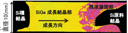
図: Hicari宇宙実験で育成したSiGe結晶の外観(上)と、SiGe結晶中のGe濃度分布(下、濃度分布を色の違いで表現) 左から右に結晶が成長し、地上実験では得られない均一組成が得られた。
