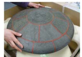
火星突入機TPS-φ500 mm BBM
