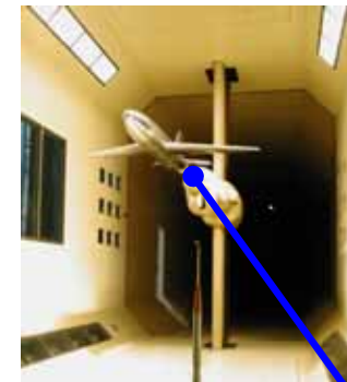
スティング支持装置
