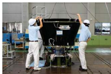
図1 2段ノズル伸展試験
