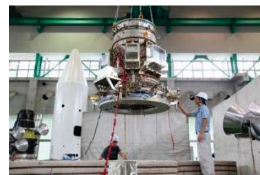
図4 PBS(ポストブースト ステージ)分離衝撃試験
