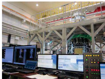
図1 2段ノズル伸展試験
