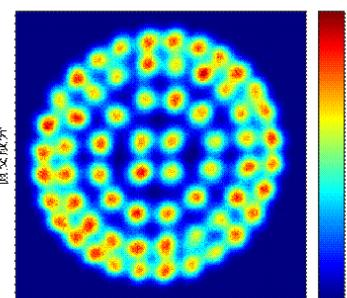
ほどよし4号から64APSK変調信号を地上で受信し復調した振幅と位相の平面図
