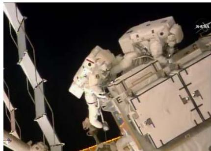
HTV6号機の曝露パレットからISS新型バッテリを取り外す宇宙飛行士
