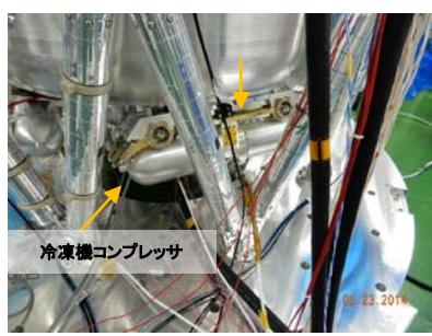
冷凍機コンプレッサおよび擾乱抑制用アイソレータ
