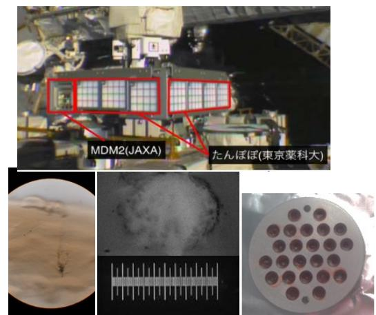
図1（上）：ISS曝露部に設置されたたんぽぽエアロゲル捕集パネル。図2（左下）：摘出された宇宙塵起源の紡錘型超高速衝突痕。図3（中下）：三次元測定を行った宇宙塵起源のお椀型超高速衝突痕（スケールは1 mm）。図4（右下）：微生物用曝露パネル試料ホルダ
