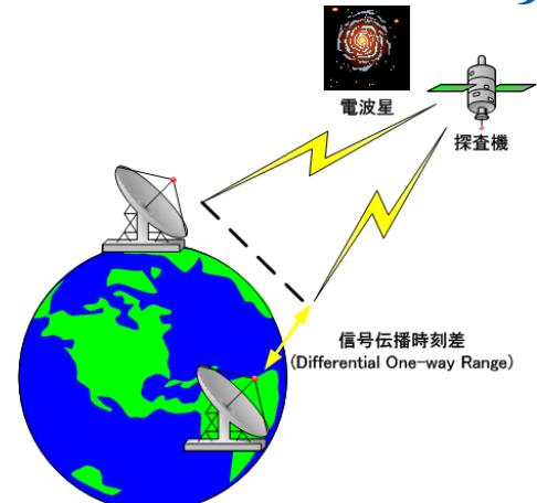
DDOR (Delta Differential One-way Range) の原理
