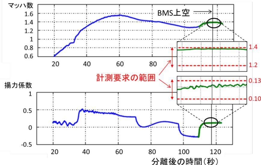
誘導制御技術：飛行状態の時間履歴
