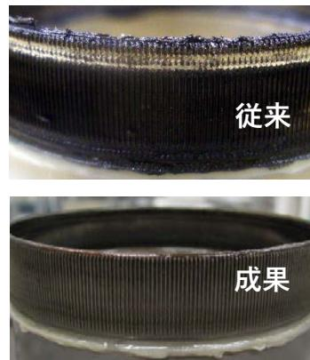
寿命を支配するしゅう動部に、「浸炭処理」と2段階の「ショットピーニング」という表面処理を適用し、耐摩耗性と油保持性を飛躍的に向上させた。約15倍の長期間作動後でも、ほとんど摩耗していない。
