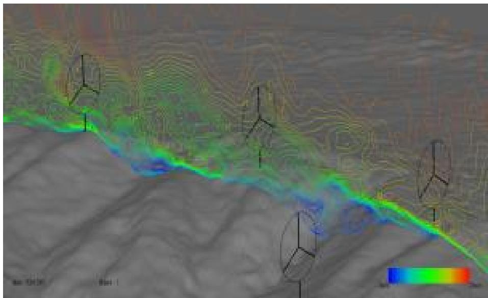
**【利用事例②】風力発電計画のための風況シミュレーション**
