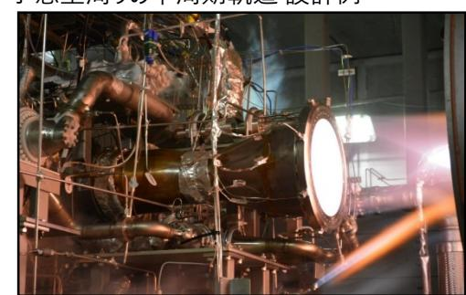
再使用エンジン燃焼試験
