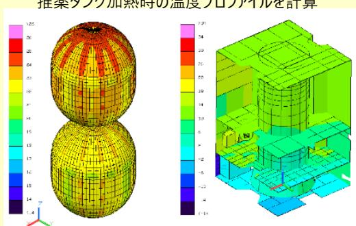
**手順③**：推薬タンク加熱時のタンク温度プロファイルを
