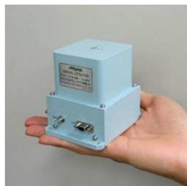
小型高精度衛星航法装置(Micro-GAIA)
