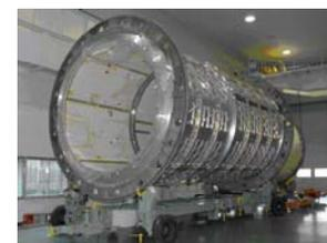
円筒モジュールのエンドドームボルト締め構造
