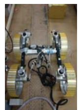
新規開発したサスペンション機構を有するローバ下部
