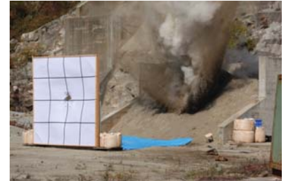
図:はやぶさ2衝突装置 飛翔性能確認試験衝突装置から射出される飛翔体について、命中精度等所定の機能実証が得られた。
