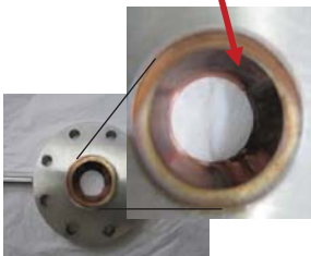
ロケットエンジン燃焼室の寿命を延ばす熱遮蔽膜の研究
