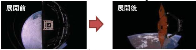
TMSAP 展開の様子 (JAXA コーディネート開発のカメラ・NB-FPGAを利用)
