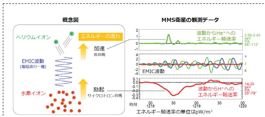
「MMS」衛星の観測から得られた電磁イオンサイクロトロン波動とそれに対応したエネルギー輸送率と概念図
