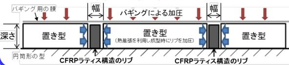
図5 段差なく正常に製造された交差部
