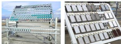
射場設備では海塩／噴煙の影響により腐食が著しく、各設備の部位に応じた防蝕対策ができるよう、射場における環境を把握し、腐食メカニズム (要因や経時性) を定量的に評価するための九州大学との共同研究について実施中
