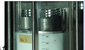
粉化対策の振動試験の様子
