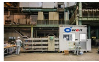
O-well社の自動リブレット形状塗膜施工システム
