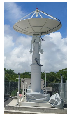
自律飛行安全システムに対応する追尾局システム
