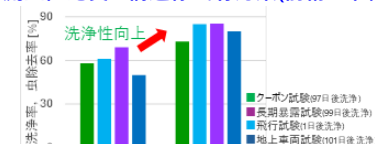
高洗浄塗料の洗浄性評価結果
