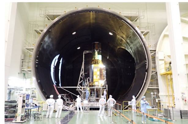
▲システム熱真空試験の様子
