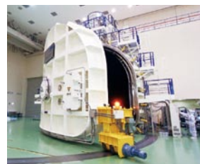
GOSAT「チャンバ内の温室効果ガス観測センサ熱真空試験（6m Φ放射計スペースチャンバの開扉）」
