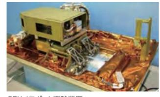
REX-Jは、宇宙飛行士の船外活動を支援・代行するロボットの実現を目指し、ロボットを開発する上で不可欠な「空間移動技術」の要素技術を実証実験するミッションです。今回、「きぼう」船外実験プラットフォームで実施した実験において、テザー(紐)制御によるロボットの空間移動技術の実証に成功しました。JAXAの宇宙ロボット技術は、これまで「きぼう」のロボットアームや技術試験衛星VII型(「きく7号」)などにより、世界的に高い評価を得ています。
