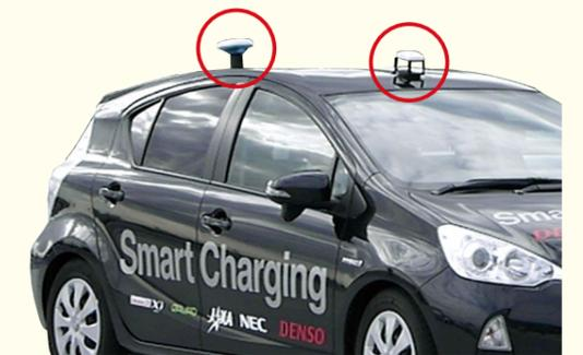
「みちびき」の LEX 信号を含む衛星信号を受信できる高精度測位用アンテナ (後方) と、車の方位を求めするためのサブのアンテナ (前方)。
