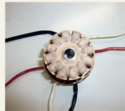
熱伝導性耐熱絶縁材料を塗布したモーターコイル(直径60mm)
