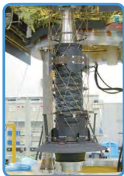
サンプリング装置(サンブラホーン) 筒状のホーン部先端が小惑星表面に触った瞬間にホーン内部で小さな弾丸を撃ち出し、表面から舞い上がった小惑星の砂れき等をキャッチする(基本設計は「はやぶさ」と同じ)。
