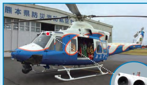
機上システムのアンテナはコックピット内上部に設置します
