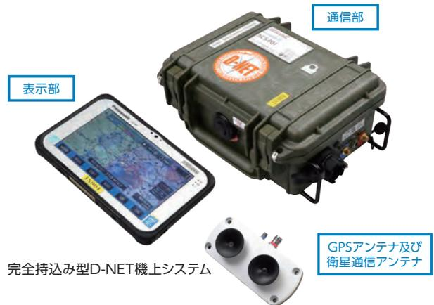
完全持込み型D-NET機上システム
