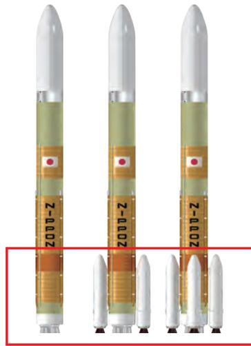
衛星の重量に応じて、1段エンジンの基数及び固体ロケットブースタの本数を変更
