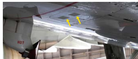
黄色矢印の箇所、航空機に施工されたJAXAのリブレット(表面摩擦抵抗を減らす縦溝構造)。各企業と協力し飛行実証実験を行いました。
