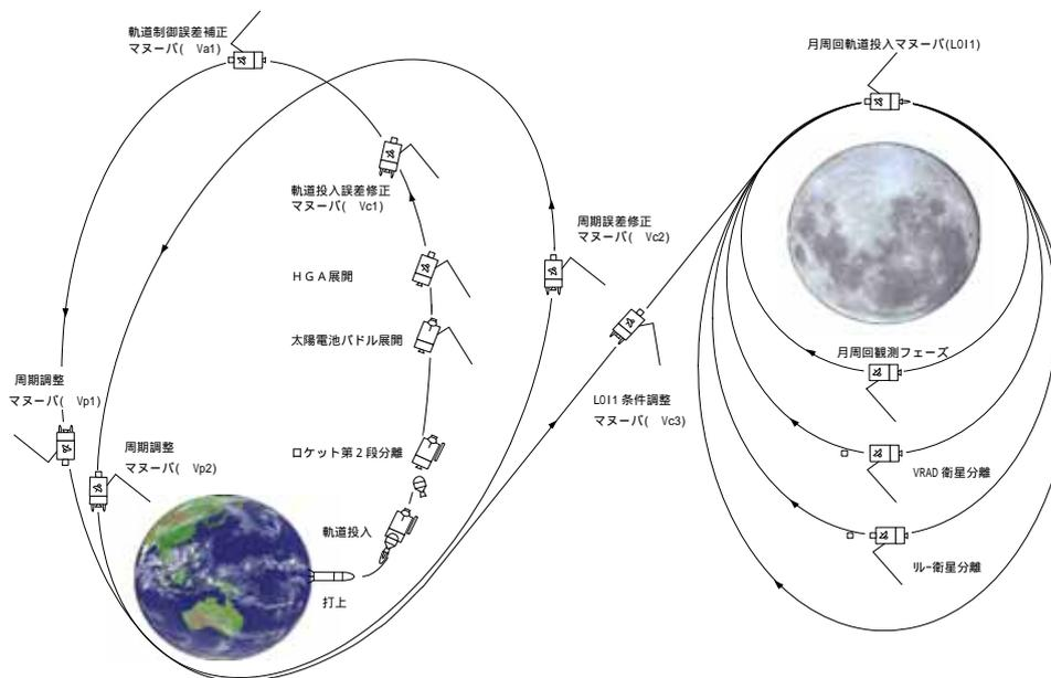
軌道投入誤差修正マヌーバ：H-IIAロケットによって投入された軌道の誤差修正、軌道面変更を目的とした軌道制御(図中 )
