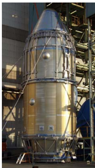
5S-H フェアリング 強度試験供試体
