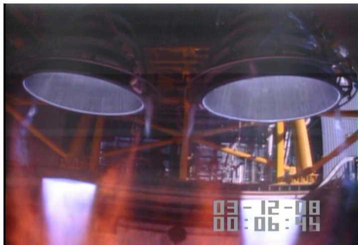
厚肉タンクステージ燃烧試験実施状況(エンジン部)
