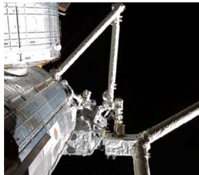
【参考】「きぼう」ロボットアームでMAXI(JAXAの船外実験装置)を取り付けているところ(STS-127)
