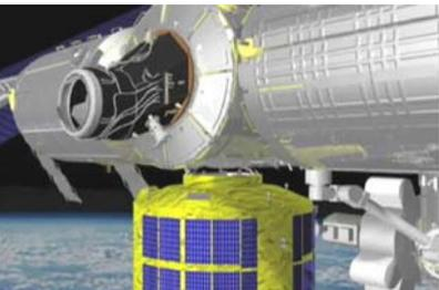
ISSクルーは、ハーモニー側から、結合部の艀装(配線・ケーブル設置等)を行ない、HTVのシステム系の再起動を行います。
