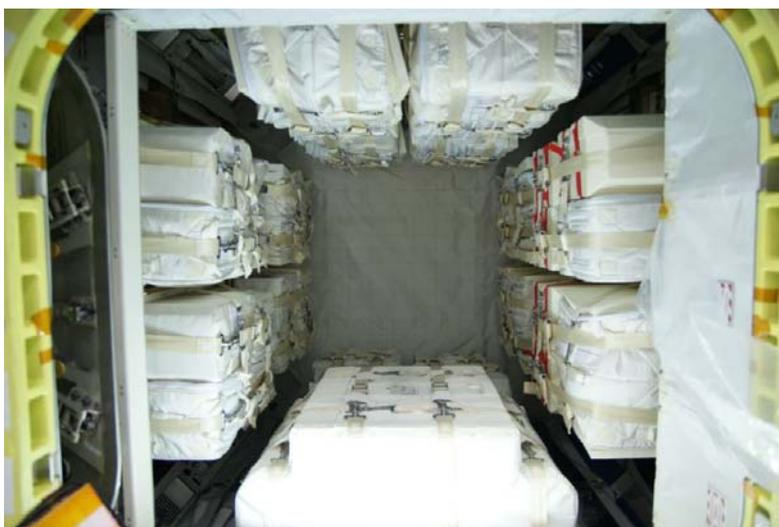
図2.3.1-5 HTV補給ラック(HRR)のPLCへの搭載状況
