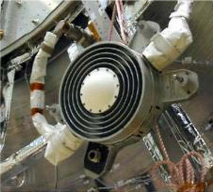
GPSアンテナは、ISSの軌道位置・速度情報をHTVへ提供するために使われます。
