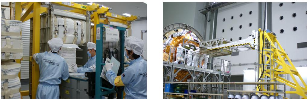
図1.3.1-1 HTV補給ラックに搭載される物資輸送用バッグ(左)と補給キャリア与圧部に搭載されるHTV補給ラック
