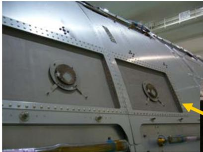
PROX通信アンテナは、ISS近傍に接近したHTVとの直接無線通信に使われます。
