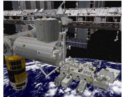
「きぼう」ロボットアームによるSMILESの船外実験プラットフォームへの取り付けイメージ
