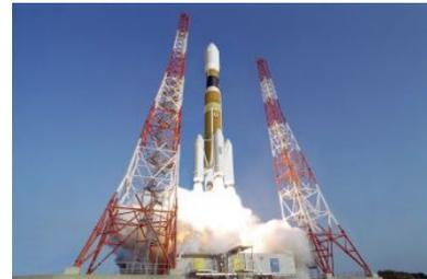
打上げから2分4秒と2分7秒後に固体ロケットブースタが2基ずつ分離し、約3分40秒後にフェアリングが分離します。打上げから約5分47秒後に第1段エンジンの燃焼が停止し、約5分54秒後に第1段が分離します。その後第2段エンジンが始動し、HTVを高度200km×300km、軌道傾斜角51.6度の所定の楕円軌道へと投入させます。第2段エンジンは打上げの約14分20秒後に停止し、打上げの約15分11秒後にHTVから分離します。
