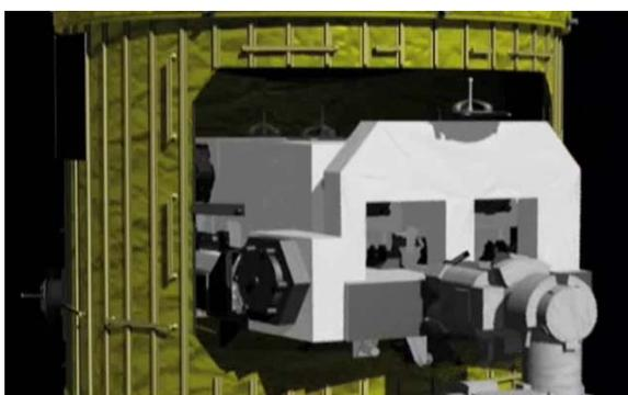
最後に、曝露パレットは、ISSのロボットアームでHTV補給キャリア非与圧部に格納されます。
