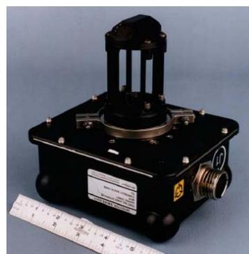
ISS結合中、煙探知機(Smoke Detector)は換気システム上に取り付けられます。
