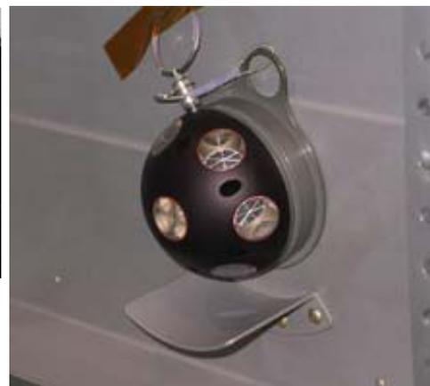
反射器(レーザレーダリフレクタ)は、「きぼう」の下部に設置されたレーザ反射鏡です。HTVがISSの下方(地球方向)から接近する際にHTVのランデブセンサ(Rendezvous Sensor: RVS)から照射されたレーザ光を反射します。
