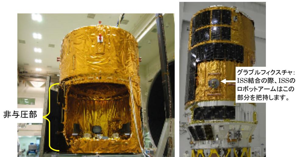
図2.4.2-1 補給キャリア非与圧部(HTV1)(左は曝露パレット搭載前)
