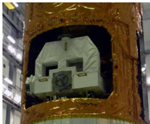
図2.4.2-3 曝露パレットを搭載した状態(HTV2)
