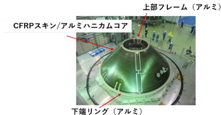
図 1.4.3-1 衛星搭載アダプタ (PSS) 外観
