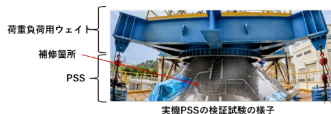
図 6.1.3-2 実機 PSS の検証試験の様子
