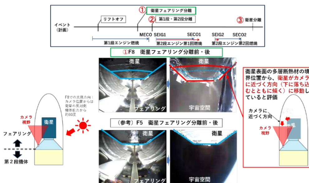
図 4.2.5-3 衛星フェアリング分離時の取得画像（衛星位置の評価）
