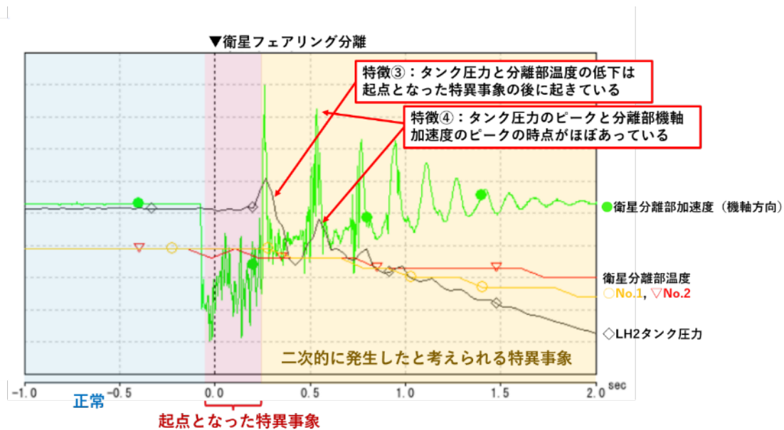
図 4.2.4-3 衛星フェアリング分離時の LH2 加圧ライン挙動（詳細）
