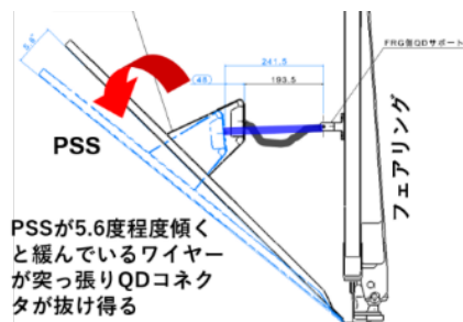
図 5.3.1-2 PSS 下部が弾性変形した場合の挙動
