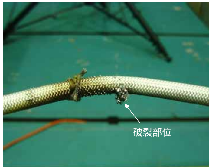
図4.1-1 導爆線加熱部(270 加熱時の導爆線破裂状況)
