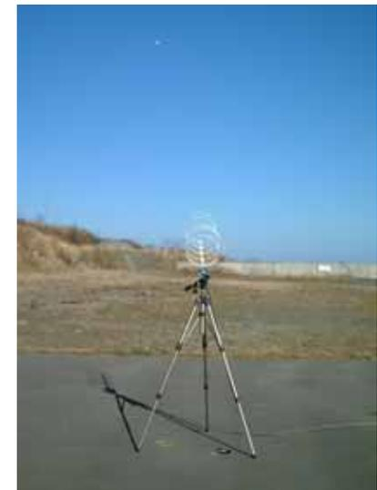
試験機方向に向けて設置された放送受信用リングアンテナ
