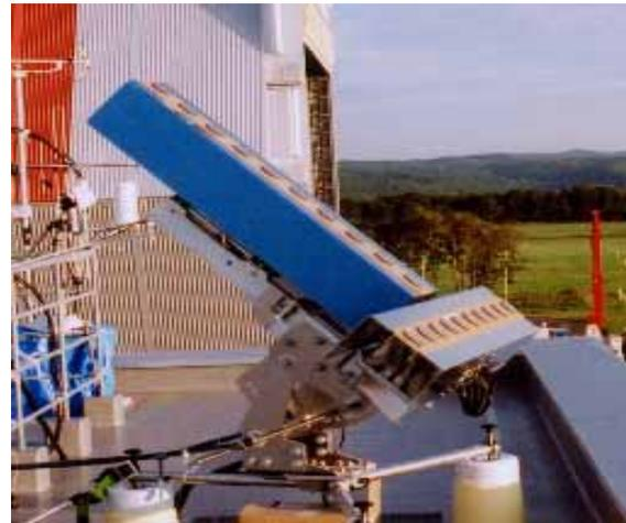
飛行管制棟屋上に設置した直交配列アレーセンサー
