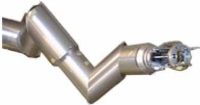
STOL実験機「飛鳥」の開発過程で生まれた「偏心流体継手」を宇宙・航空分野や民生分野へ応用することにより開発された技術。
