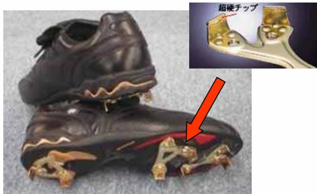
超硬合金(WC-Co系合金)は、土砂に対して極めて耐摩耗性に優れています。激しい野球の動きの中で生じる、突発的な衝撃に対処するため、シャンク部と境界部に衝撃緩和機能を持たせ、超硬合金への負荷が軽減される構造を開発。ミズノ株
