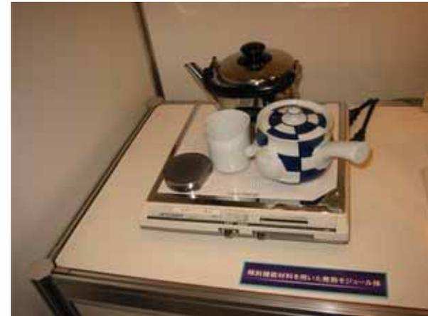
1800 以上の高温にさらされることを考慮して開発された、表面に耐熱性に優れたセラミックス、取付面に耐強度性に優れた金属組成を有する材料技術です。発熱容器等への活用が想定されます。
