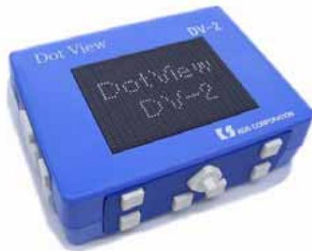
目の不自由な人たちがコンピュータを操作できるよう、ディスプレイに表示される図形や動画を手触りで識別できるように作られたシステム。パソコンに接続して図形情報を点図の形でリアルタイムに表示できます。
