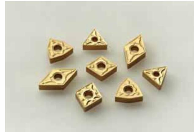
新開発の表面傾斜構造を持つ超硬母材とトリプル構造のCVD(化学気相蒸着)コーティング層との組み合わせにより耐塑性変形性と耐欠損性を同時に向上させたスローアウェイチップ切削工具用材種“UE6020”です。
