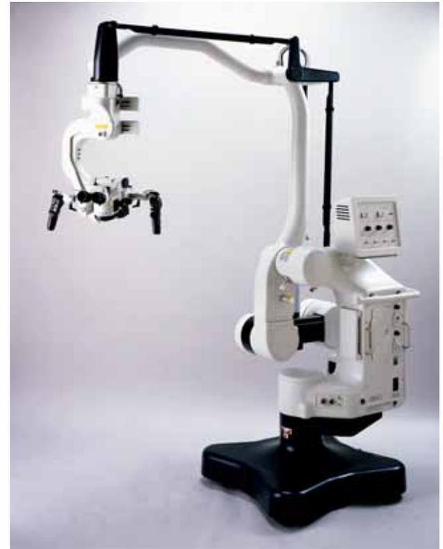
宇宙観測用機器(X線観測機器)用駆動部のバランスシステムを活用した脳外科手術用顕微鏡・スタンド。
