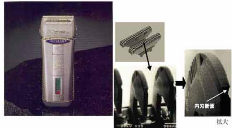
刃は、鋭角なほど切断能力はアップします。ステンレス薄板の微細精密塑性加工技術を開発し、それを適用し創製した硬度傾斜機能材を内刃に採用し、刃先角 $60^\circ$ のシャープなエッジを達成。
