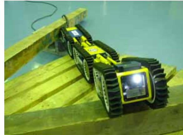
東京工業大学 広瀬研究室とNPO法人国際レスキューシステム研究機構が共同開発した、瓦礫内探査ヘビ型ロボット「IRS蒼龍(そうりゅう)」。防塵(ぼうじん)、防水を施し、赤外線センサー等を装備。
