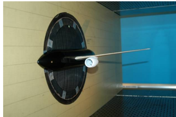
(図1)フラッタ解析ツールを確立するためのフラッタ風洞試験
