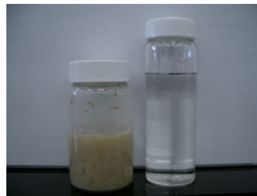
焼酎廃液の分解例(左:廃液、右:生成水)
