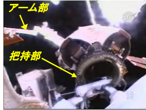
ロボットアームの把持部への 潤滑剤塗布の様子
