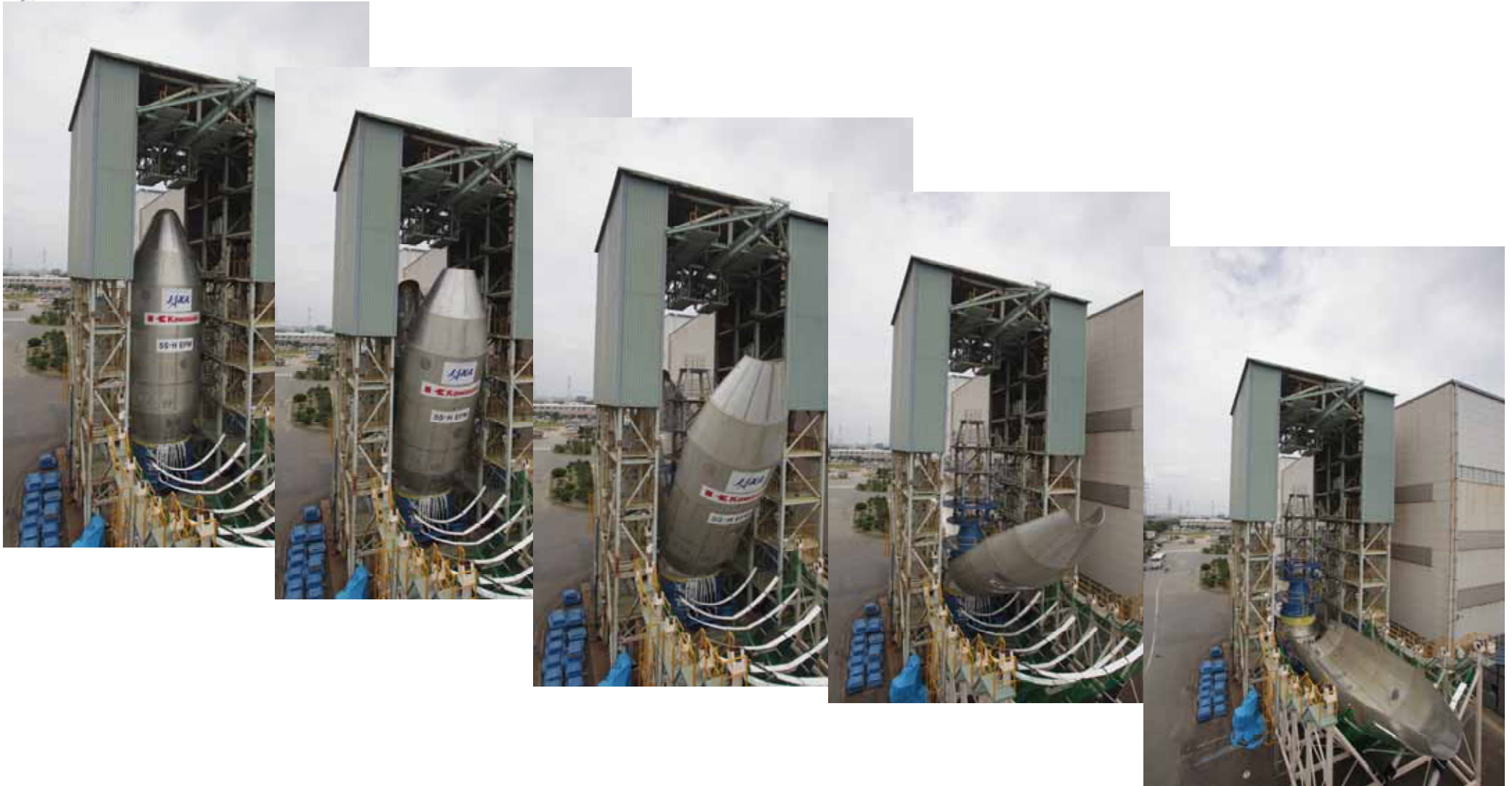
フェアリング分離放てき試験状況(7月21日第1回試験、於川崎重工業(株)播磨工場、軸方向から見る)
