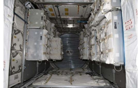
上記のラック・装置に加え、多数の交換機器、部品、補給品が、補給品保管ラック(RSR)と補給品保管プラットフォーム(RSP)に搭載されて運ばれる。
