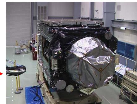
衛星組立後電気性能試験
