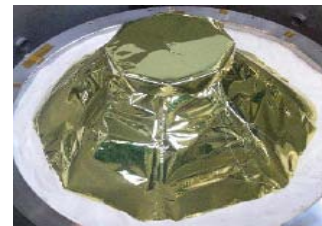
観測機器の熱真空試験
