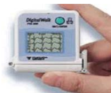
写真1:軌道上における心電計測に用いるホルター心電計
