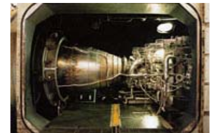
(※)高空燃焼試験 地上にて、真空状態を模擬して行う燃焼試験 (写真はLE-5Bエンジン)
