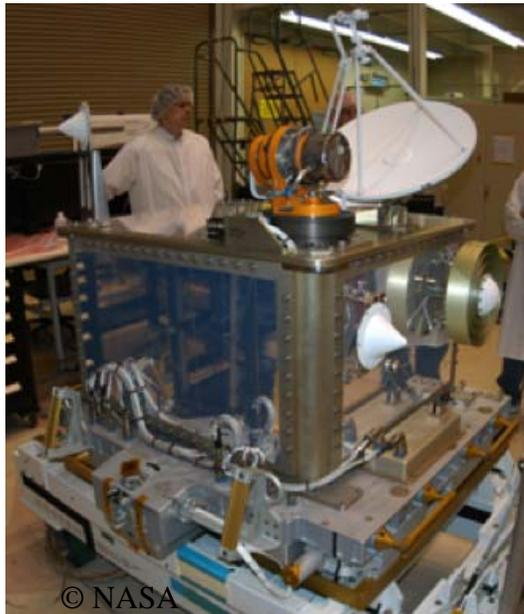
宇宙空間通信手段の一つである次世代のSDR(Software Defined Radios: ソフトウェア無線)の試験を行うNASAの実験装置
