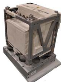
「きぼう」冷却水 循環ポンプ
