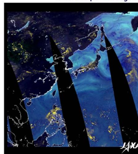
図は、「しずく」搭載のAMSR2が日本周辺を観測した擬似カラー合成画像で、89.0GHz垂直・水平偏波、23.8GHz垂直偏波の輝度温度を使用しています。「しずく」は平成24年7月3日午後1時頃(日本時間)に日本の上空を通過しました。このとき、日本の上空には梅雨前線が停滞し、四国の東側や近畿東海にかけて広い範囲で強い雨が降っている領域が黄白色に見えています。また、日本の東海上には低気圧による水蒸気と雲の分布が、水色と紺色の渦状にみられます。
