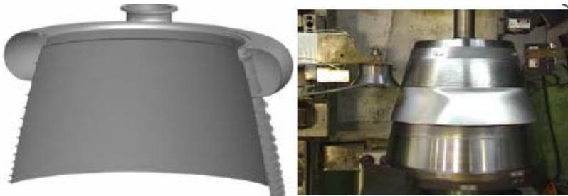
スピンフォーム成形により材料費、加工工数を低減
