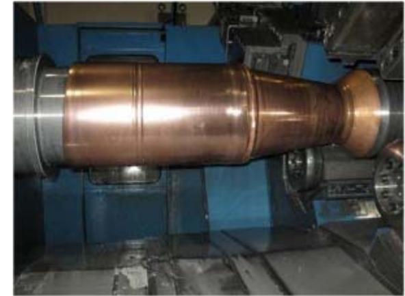
銅合金製の燃焼室を切削加工から絞り加工に変更して材料費、加工工数を削減
