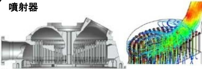
燃料が流入する部分の流れを正確にシミュレーションすることにより、形状をできるだけ簡素化して低コスト化
