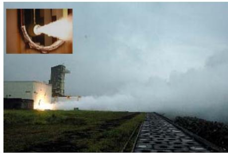
上段サブサイズモータ地上燃焼試験
